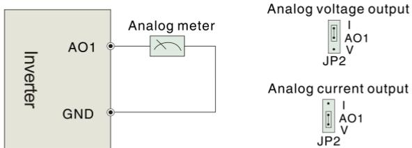
Fig. 3-9 Analog output terminal wiring
