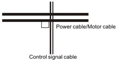
*Fig. 3-14 orthogonal wiring*
