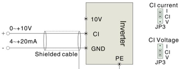
Fig. 3-8 CI terminal wiring
