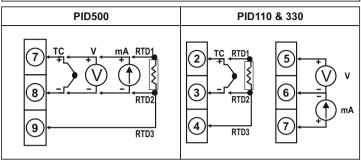
TC - Thermocouple (J, K, T, R, S, C, E, B, N, L, U, W, Platinel II).
